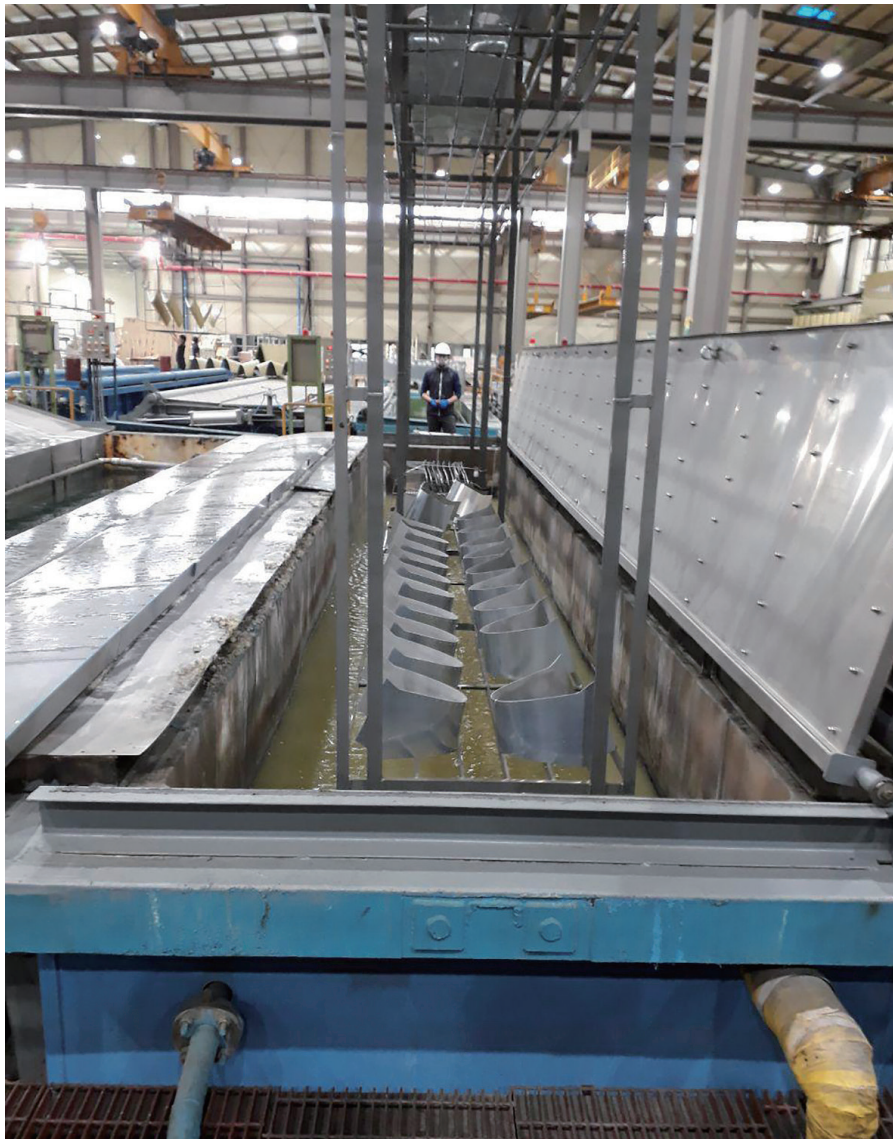
도금 작업이 표면에 막을 입히는 기술이라면, 아노다이징 작업은 금속 표면에 양극 산화막을 코팅하는 기술이다. 결국, 기술상 차이는 전기 도금은 금속을 음극으로 하여 음극 환원 반응을 이용하는 것이고, 아노다이징은 금속을 양극으로 하는 표면처리 과정이다.
