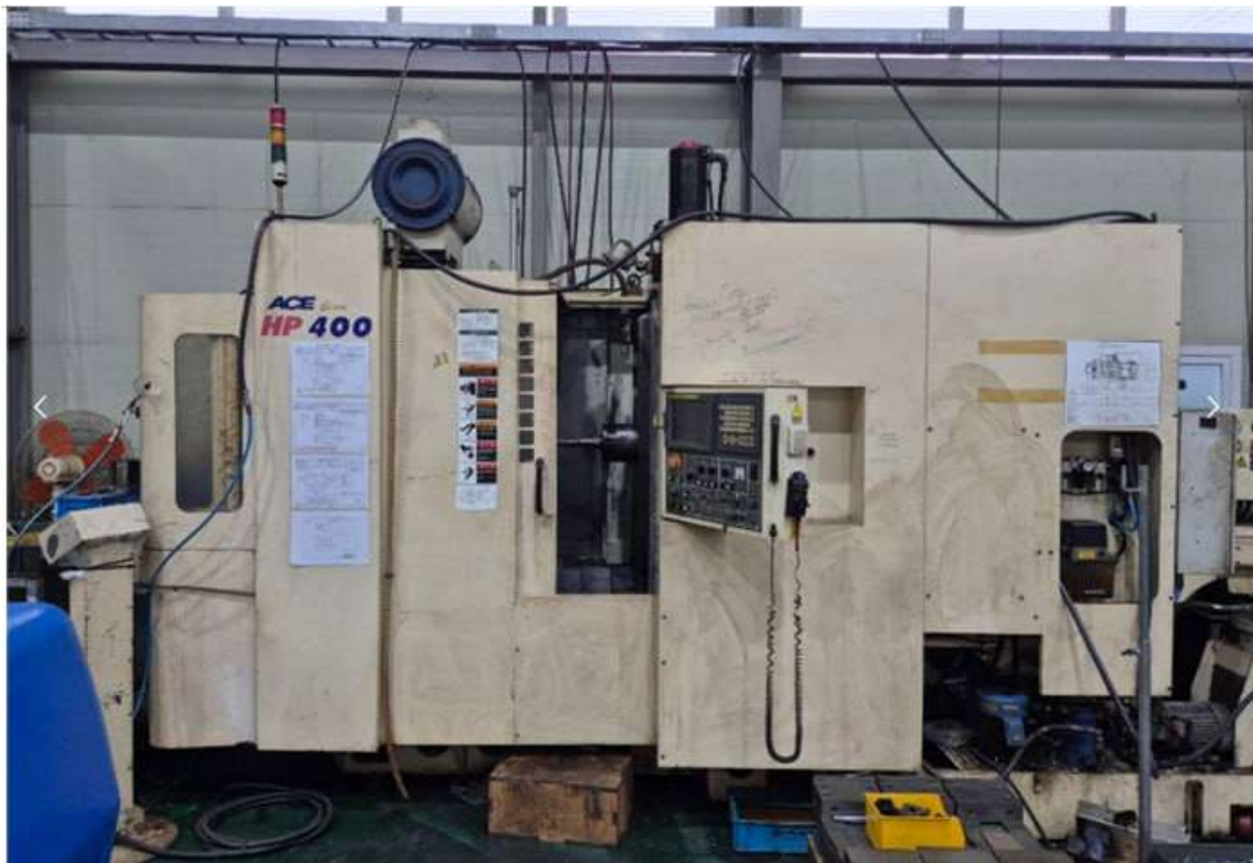
사고 설비와 같은 모델(앞면), 인터록이 설치되어 있지 않음.
